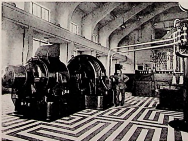
Afb. 4. Telefunken-machinezender te Kootwijk (1923). Deze leverde 200 kW antenne-energie. Roepletters: PCG.
